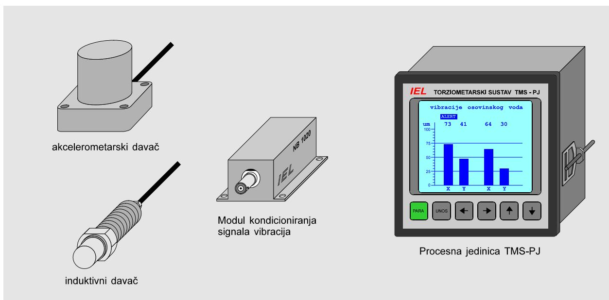
Osnovni elementi podsustava mjerena vibracija
